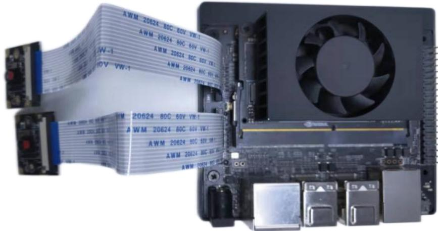
风扇: JetsonTX2-NX 国产套件自带风扇,该风扇默认是跟随温度的变化值自动开启,可以通过修改/sys/devices/pwm-fan/target\_pwm 进行风扇速度控制,数值范围是 0-255,该控制在完全断电在开机后会重置,所以仅对当次设置有效,另外可通过安装 jtop 对设备风扇进行控制。
