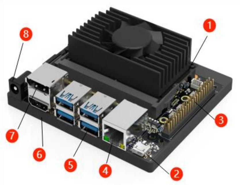
接口 1: tx2-nx 模块, 区别于 nvidiaTX2-NX 开发套件在于 nx 模块存储结构不同, jetsonTX2-NX 国产套件采用的 tx2-nx 模块自带 16g emmc 存储, 系统安装于此存储环境之中;
