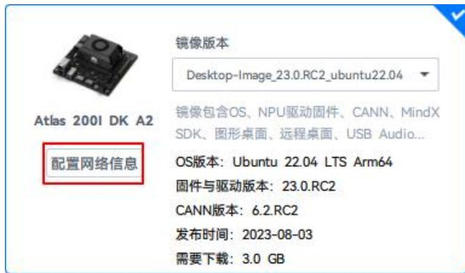
**(重点阅读)**如果不修改网络信息，则镜像烧录完成后，开发者套件 eth1 网口默认静态 IP 地址为 192.168.137.100；eth0 网口为 DHCP 动态模式，未分配 IP 地址；Type-C 接口默认静态 IP 地址为 192.168.0.2。
